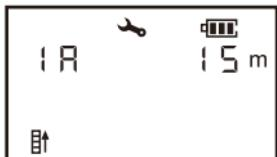
2)将仪器安放在测站1照准尺A按[MEAS]键测量；
