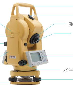
粗瞄准器望远镜调焦环望远镜目镜
