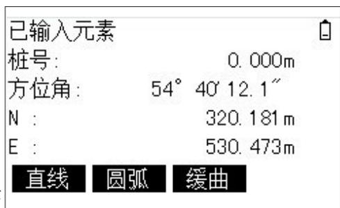
按其中一个软功能键，输入相应的信息，即可生成定线元素然后返回到该界面，仪器自动计算桩号、方位角和坐标数据。此时继续定义其它线型，新线型只能加到原定线文件的后面。
